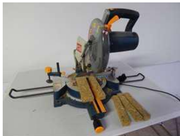
Рис. 1. Виготовлення зразків балок для випробування на міцність на вигин
