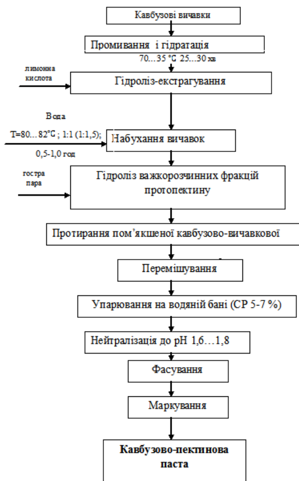
Рис. 1. Принципово-технологічна схема отримання кавбузово-пектинової пасти
