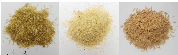
А Б В Рис. 1. Досліджувані матеріали: А – волокна ячмінної соломи; Б – заповнювач серцевини кукурудзи; В – рисове лушпиння
