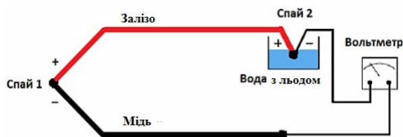
Рис. 5. Термовимірювальний контур, у якому другий спай занурений у воду з льодом
