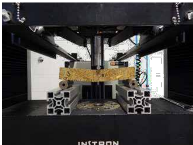
Рис. 2. Загальний вигляд випробування зразків балок на міцність на вигин
